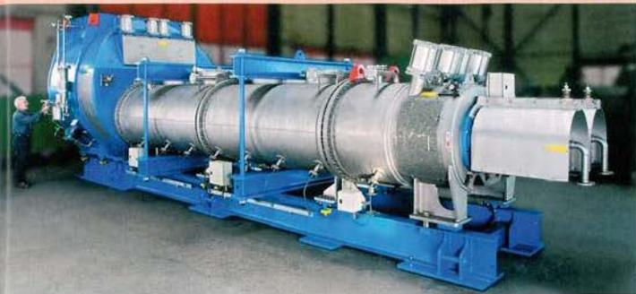
Mit der KneaderReactor-Technologie können mit geringerem Energieaufwand gleiche oder sogar bessere Produktqualitäten erzielt werden
