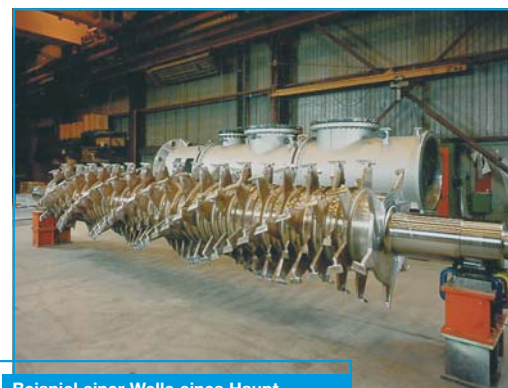
Beispiel einer Welle eines Hauptaussdampfers in Produktionsgröße
