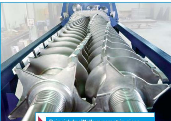
Beispiel der Wellengeometrie eines Finishers in Produktionsgröße
